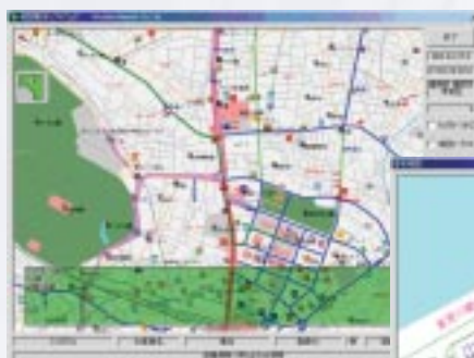
指令情報、地図情報はPCならではの10.4型TFTモニターで確認。道路地図上でナビゲーションを行うほか、適宜住宅地図で詳細確認を行うこともできる。
